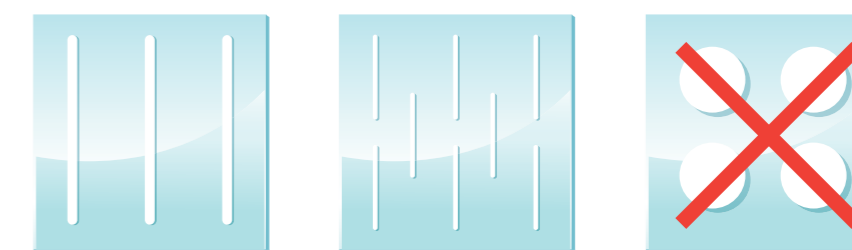
沿垂直条纹的方向使用粘合剂（胶水/胶带）
